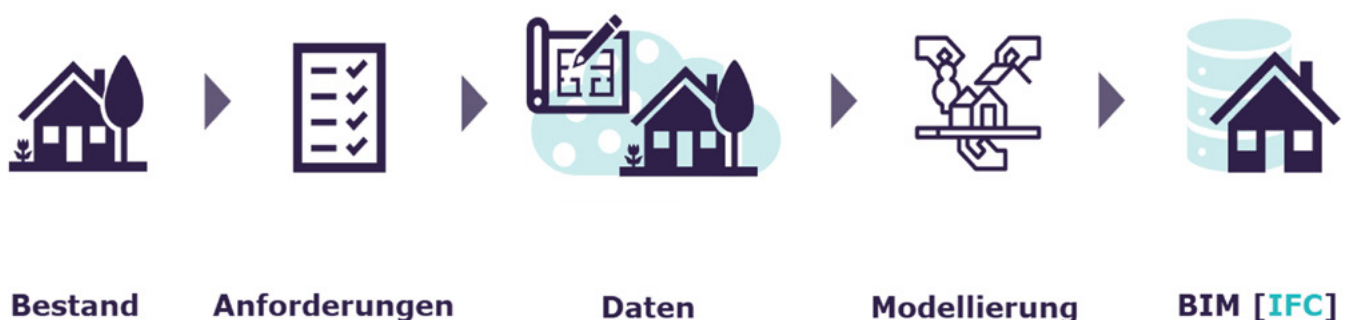
Abbildung 17: Genereller Arbeitsablauf der Bestandsmodellierung 113
