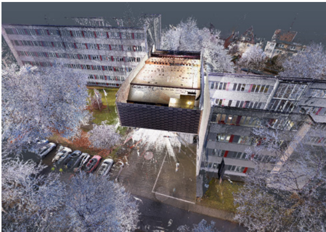
Abbildung 29 : L-Punktwolke des TLS Trimble-X7 des Alice-Salomon-Berufskollegs (Außenansicht und Innenansicht der Aula) 128
