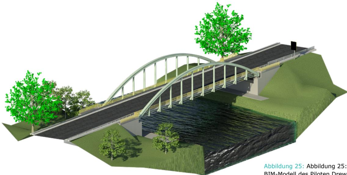
Abbildung 25: Vollständiges BIM-Modell des Piloten Drewer Brücke<sup>124</sup>
