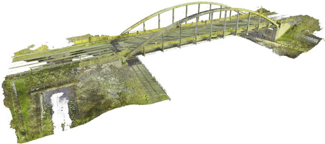
Abbildung 24: Punktwolke des TLS Leica RTC360<sup>123</sup>
