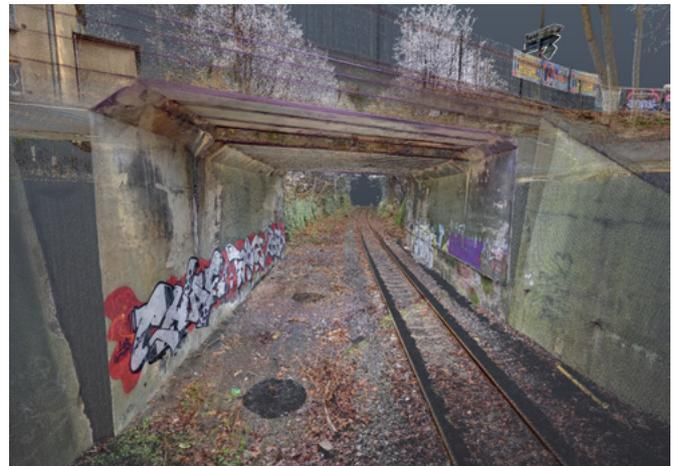
**Abbildung 21:** Punktwolke des Gesamtareals „Brücke und Straße“ des TLS Trimble-X7 mit in orange-weiß gekennzeichneten Scannerstandorten (links) und Punktwolke des TLS Zoller + Fröhlich Imager 5016 der Nahansicht der Brücke<sup>119</sup>
